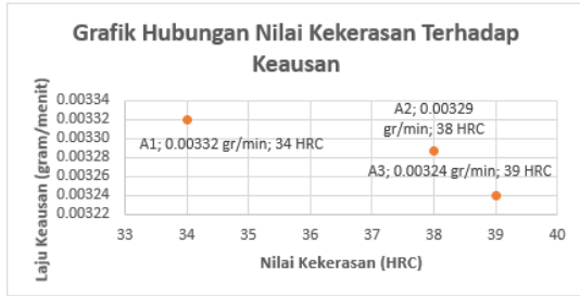
Gambar 4.4 Grafik Hubungan Nilai Kekerasan Terhadap Keausan AISI 4140
